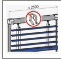
Construction de stores autoporteuse
