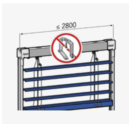
La construction autoporteuse de store protège l'isolation dans le linteau, tout en réduisant les coûts d'entretien. Jusqu'à une largeur de 2800 mm, le système se dispense d'une fixation de la traverse supérieure, de sorte que l'isolation reste intacte et les bruits sonores ne sont pas propagés.
